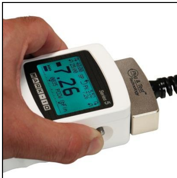
Fig. 3.2 Per lo sblocco del connettore Plug & Test™, premere entrambi i pulsanti sui due lati dell'alloggiamento dell'indicatore.
